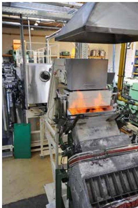
Bild oben: An den Härteöfen schließen sich die Waschmaschinen zur Reinigung der Schrauben an (links)
