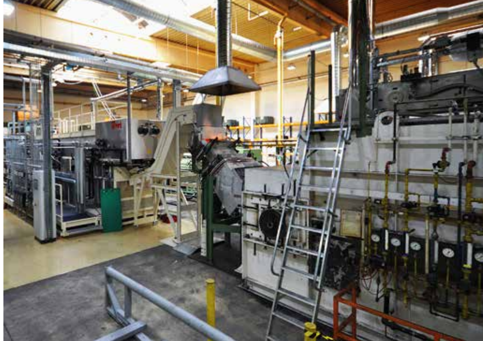
Bild oben: An den Härteöfen schließen sich die Waschmaschinen zur Reinigung der Schrauben an (links)
