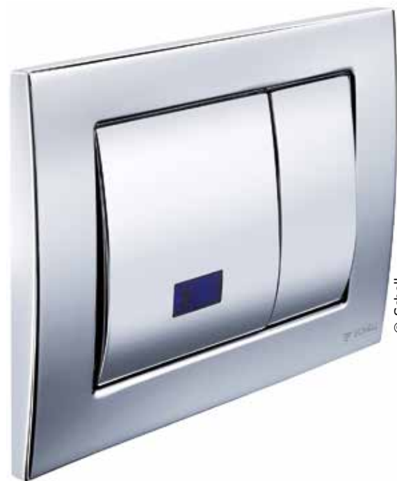
Bild 6: WC-Spülkästen mit einer automatischen Stagnationsspülung sorgen für einen regelmäßigen Wechsel des Kaltwassers auch in ungenutzten Wohnungen. Sie schützen damit automatisch auch die benachbarten Wohnungen vor Kontaminationen, denn es steht am Abzweig der Steigleitung zur ungenutzten Wohnung immer Trinkwasser von hoher Güte an
