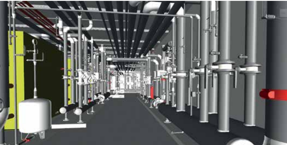
Die Installationen der modernen Gebäudetechnik in einem der technischen Räume des Hilton Schiphol Hotels im BIM-Modell (Illustration: Unica)
