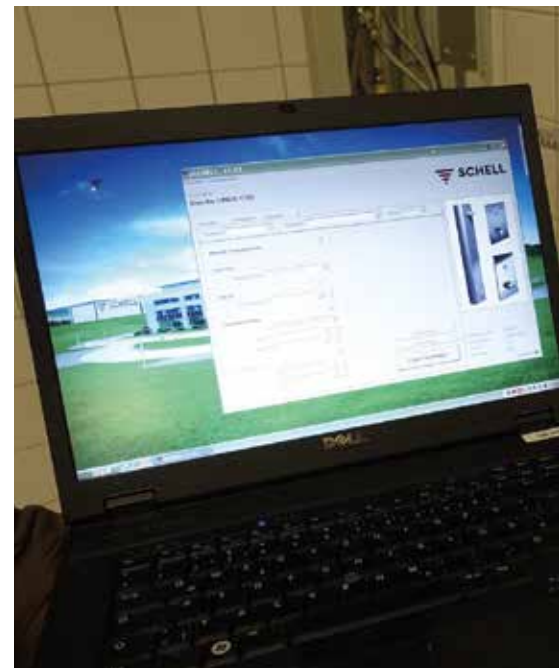
Mit der kostenlosen Software „eSCHELL“ lassen sich Programmiervorgänge elektro-nischer Schell-Armaturen und Duschpaneele einfacher gestalten und durch verlässliche Diagnosen Fehler schneller beheben.
