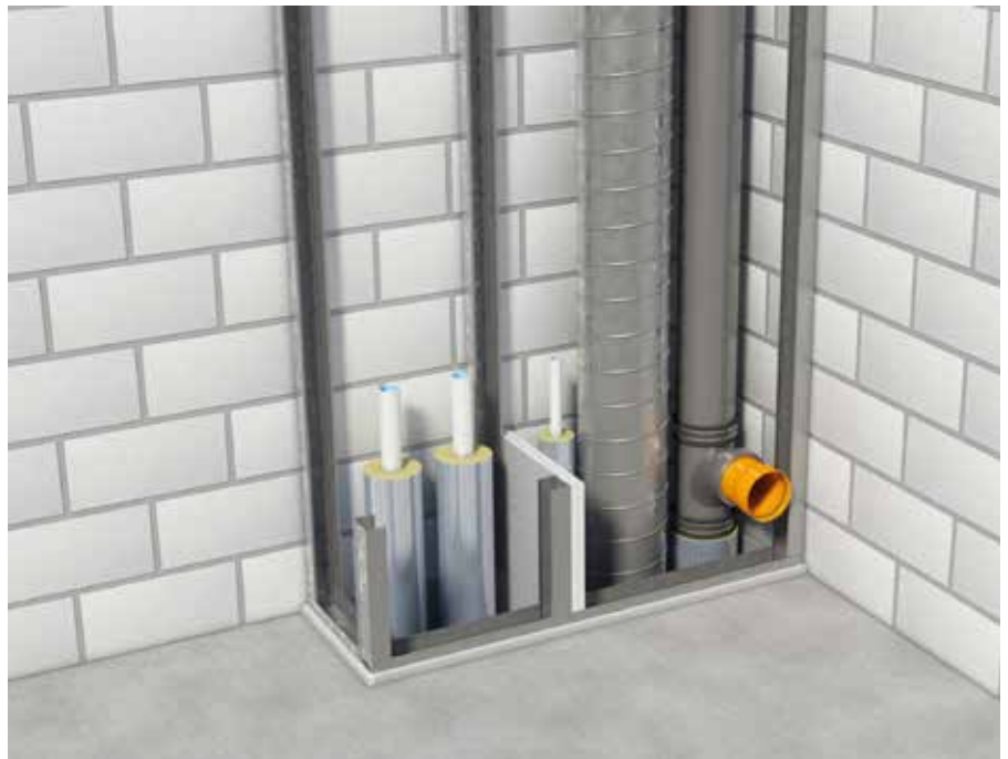
Bild 4 Durch den Verzicht auf Steigleitungen PWH und PWH-C ergeben sich kleinere Schächte.
