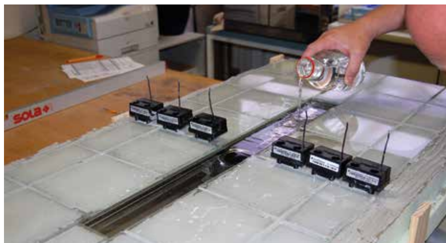
Bild 5: Der Versuch beginnt mit dem Füllen der Duschrinne bis zur Oberkante der Fliesen. Dieser Versuchsabschnitt lief über sechs Tage. Der Flüssigkeitsverlust durch Eindringen in das Fliesenbett und durch Verdunstung wurde stets ausgeglichen.
