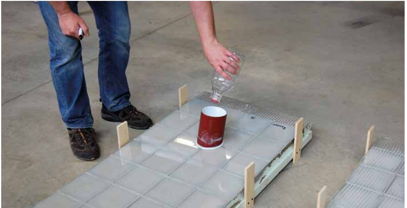
Bild 1 In Versuchsreihen mit Glasfliesen konnte das Österreichische Forschungsinstitut in Wien nachweisen, dass unter Fliesen eingedrungenes Wasser weder in Richtung eines Gefälles abfließt, noch sich über eine zweite Entwässerungsebene entsorgen lässt.
