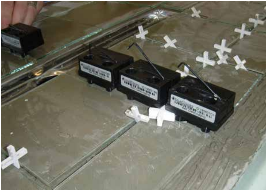
Bild 4: Aufbau des Prüfkörpers für den zweiten Versuch: Die Fliesen haben ein Gefälle hin zur Duschrinne. In das Mörtelbett wurden zudem sechs Feuchtesensoren eingebaut, die den Feuchteverlauf unter den Fliesen aufzeichnen.
