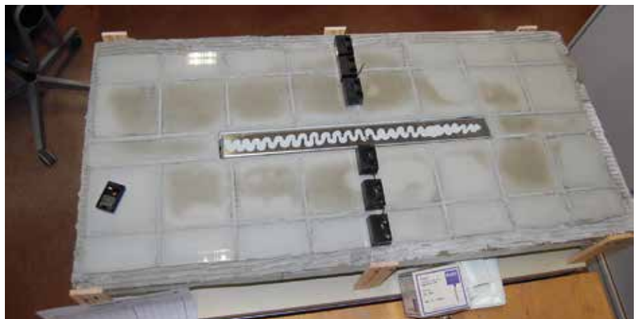
Bild 7: Der Prüfkörper mit Duschrinne nach 15 Tagen Trocknung. Immer noch sind durchfeuchtete Bereiche unter den Fliesen mit bloßem Auge deutlich erkennbar. Diese sind vor allem in der Mitte der Fliesen, wo die Wege für die Diffusion zur Umgebungsluft länger sind.
