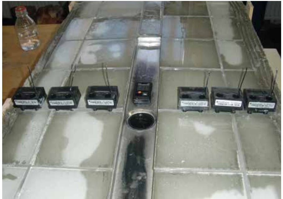
Bild 6: Am Ende des ersten Versuchsabschnitts ist eine starke Durchfeuchtung des Fliesenbetts aufgrund von Kapillarkräften zu beobachten. Während der Trockenperiode über 31 Tage wird in die Duschrinne zusätzlich ein Datenlogger zur Feuchtemessung eingelegt.
