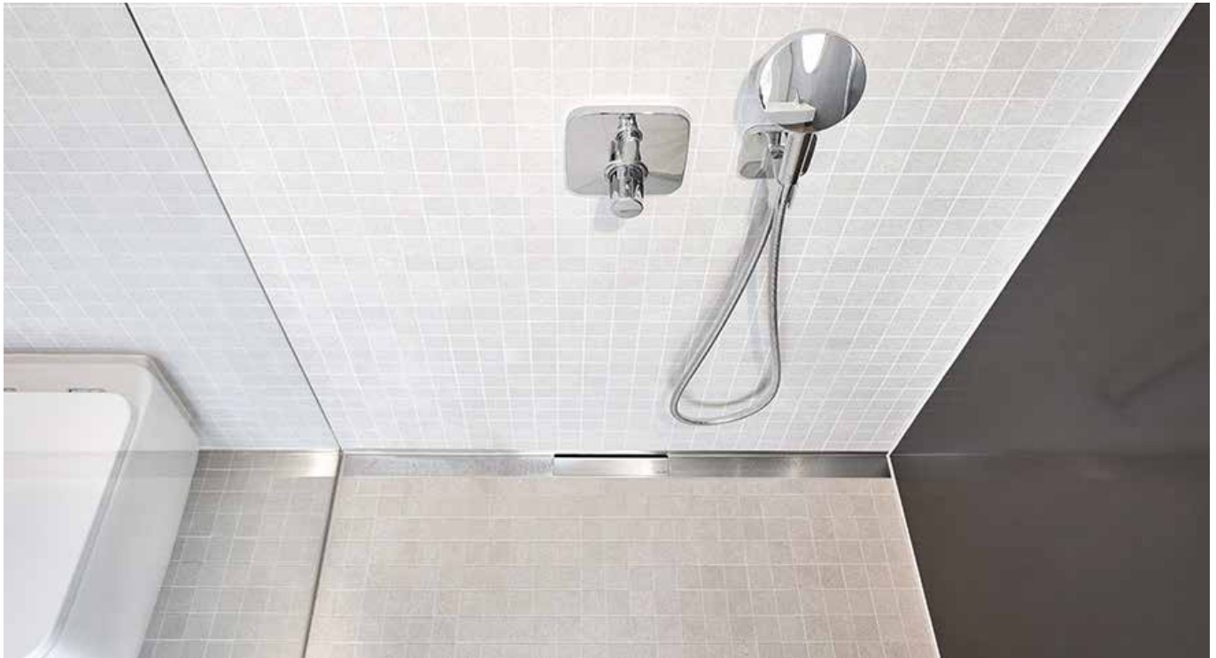
Die CeraWall Select wird am Übergang zwischen Wand und Boden installiert und leitet das Wasser zentral in das Ablaufgehäuse DallFlex. Die Aufkantung der Duschrinne sorgt für ein Plus an Sicherheit, da die Fuge oberhalb des Nassbereichs liegt.
