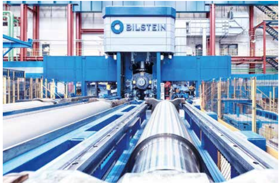
■ Mit dem neuen BILSTEIN Quarto-Reversier-Walzgerüst 1.350 mm hat die BILSTEIN GROUP den Stammsitz in Hagen-Hohenlimburg weiter ausgebaut – und sich weltweit innovativ positioniert. (Bildrechte: BILSTEIN GROUP).
