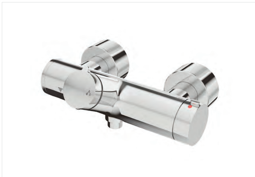
I Abbildung 4: Beispiel für eine thermostatische Duscharmatur mit mechanischer Begrenzung der maximalen Auslauftemperatur mittels Arretierscheibe auf 38°C, die nur mit Werkzeug außer Kraft gesetzt werden kann. Eine thermische Desinfektion ist dennoch möglich.
