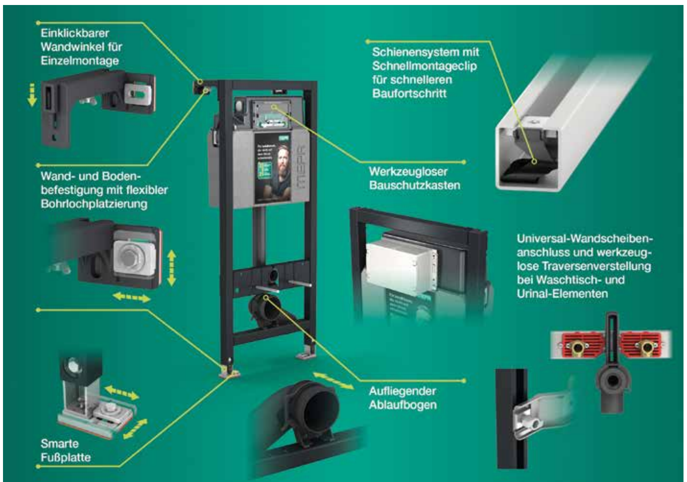
! Clevere Details für eine schnelle und einfache Montage.
