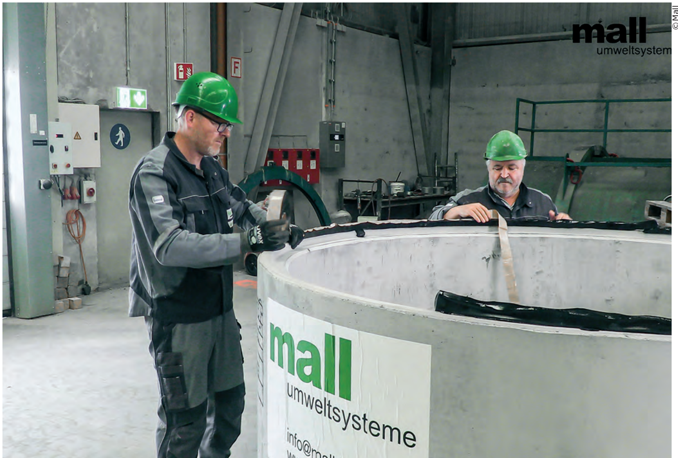
! Fertigteilbehälter aus Beton werden im Herstellerwerk so weit wie möglich für den direkten Transport zur Baustelle vorbereitet. Für Rohrverbindungen sind Öffnungen mit Dichtungsmanschetten im Behälter vorhanden.
