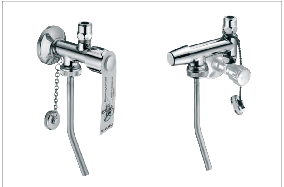
I Bild 2: Das Probennahmeventil PROBFIX von Schell (rechts) mit Anschluss für Armaturenschläuche ist zum Nachrüsten zwischen Eckventil und Armatur geeignet. Zum Einbau ist lediglich das vorhandene Eckventil abzusperrern. Beim Probennahme-Eckventil mit vandalengeschützter Betätigung (links) kann zur Probennahme zusätzlich das Rohr entfernt und dessen Abgang verschlossen werden.
