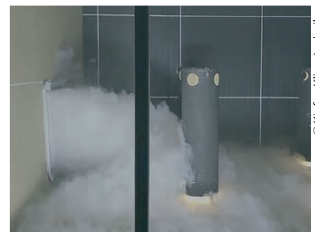
Mittels Nebelfluid konnte die Ausblascharakteristik des Luftauslasses getestet und die Luftverteilung im Raum ohne (M1) sowie in Abhängigkeit der verschiedenen Stoffmuster (M2-M5) geprüft werden.
