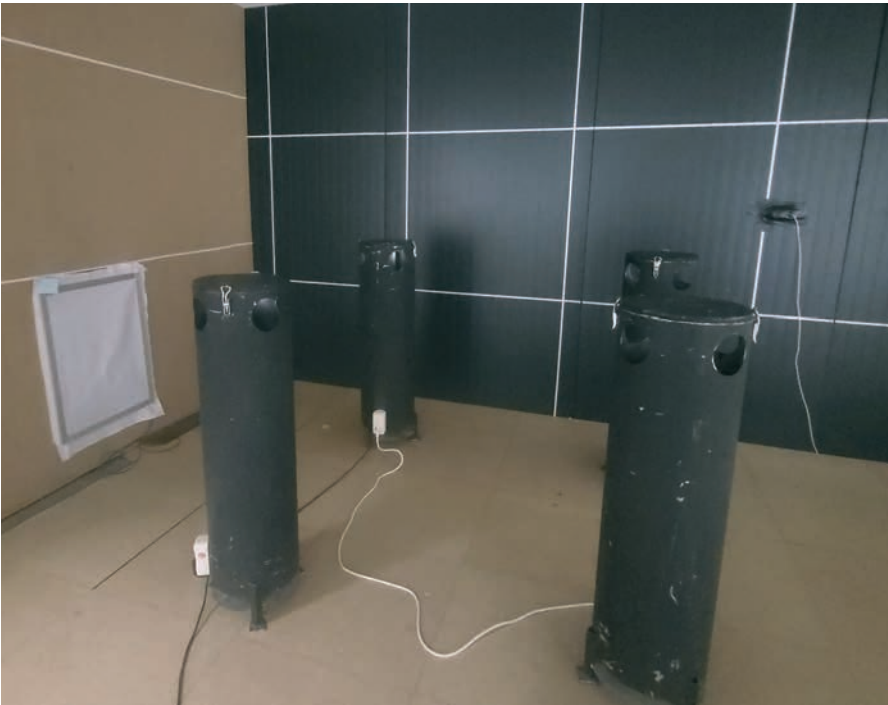
Für die Prüfstrecke wurde ein Musterraum mit INDUQUELL DIV Auslassmuster in Sonderbauform sowie Simulationen zu Personen- / und Maschinenlasten gebaut.
